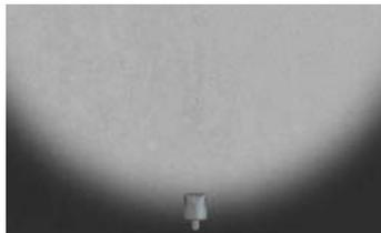
L'optique asymétrique large permet de couvrir des surfaces loin devant le luminaire, mais aussi, loin sur les côtés.
